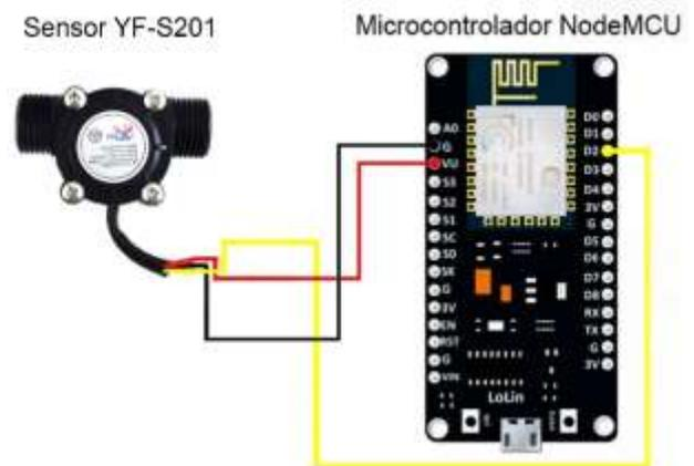
**Figura 9** Diagrama de conexión de sensor YF-S201 con microcontrolador
