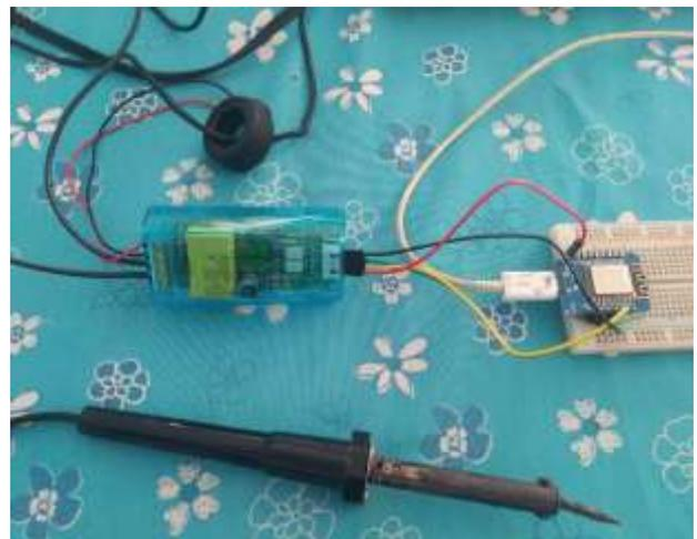
**Figura 6** Planta de prueba para el sensor de energía eléctrica
