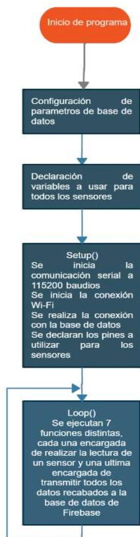
**Figura 23** Diagrama de flujo de script para prototipo
