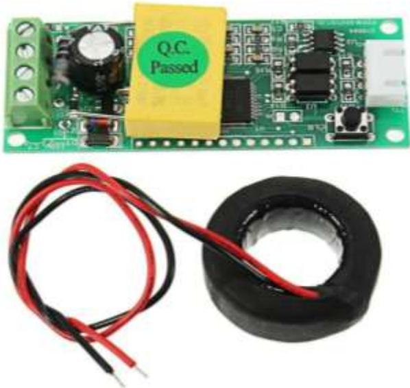
**Figura 3** Sensor PZEM-004T y transformador de corriente
