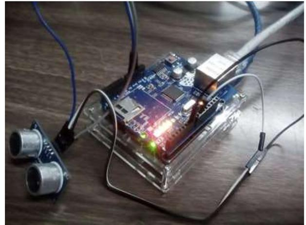
**Figura 2** Shield de Ethernet y Arduino
