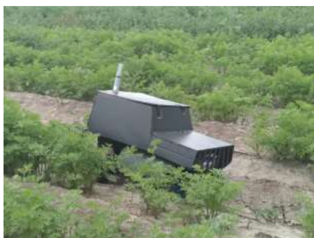
Figura 4 Prototipo de la Estación Meteorológica Automática Móvil realizando muestreo en campo
