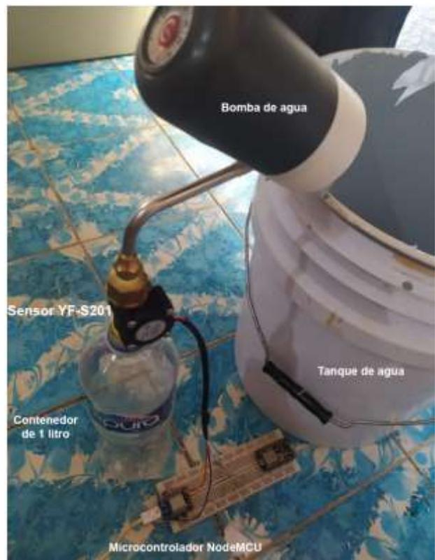
**Figura 10** Planta de pruebas para sensor de agua YF-S201
