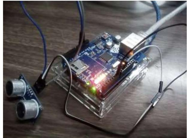
**Figura 2** Shield de Ethernet y Arduino
