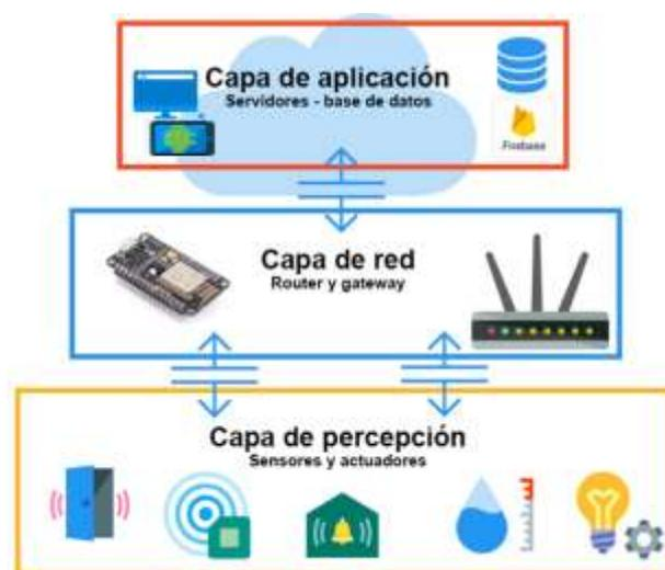
**Figura 2** Arquitectura basada en el modelo de tres capas del internet de las cosas
