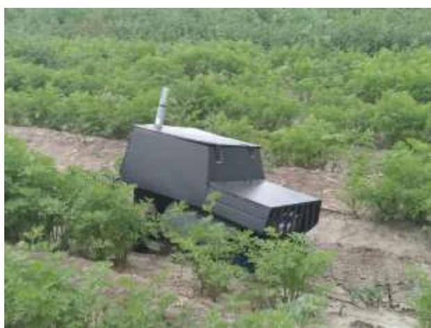
**Figura 4** Prototipo de la Estación Meteorológica Automática Móvil realizando muestreo en campo
