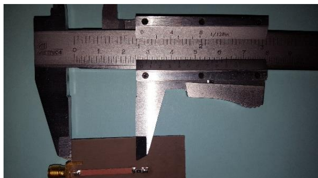
Figura 7 Longitud del Transformador 1/4
