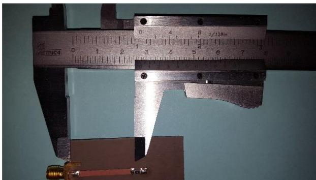
Figura 7 Longitud del Transformador 1/4
