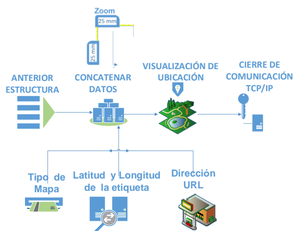
Figura 5 Representación en bloques de obtención de coordenadas GPS LabVIEW
