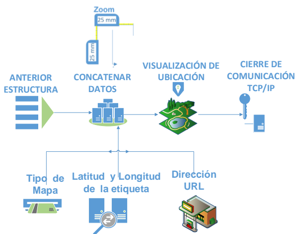
Figura 5 Representación en bloques de obtención de coordenadas GPS LabVIEW Fuente: Elaboración propia
