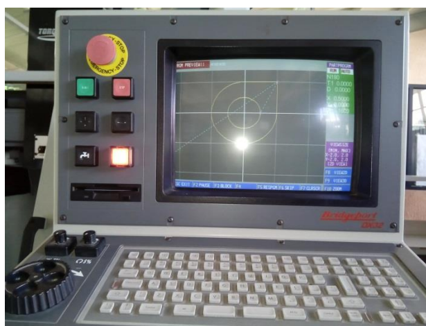
Figura 6. Ejecución de programa ejemplo en máquina de 3 ejes marca Bridgeport
