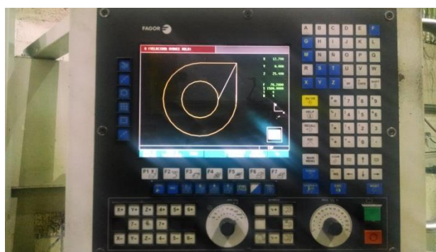
Figura 7. Ejecución de programa ejemplo en máquina de 3 ejes marca Fagor
