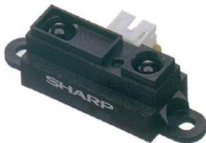
Figura 4 Sensor Sharp análogo Fuente: http://www.sharpsma.com
