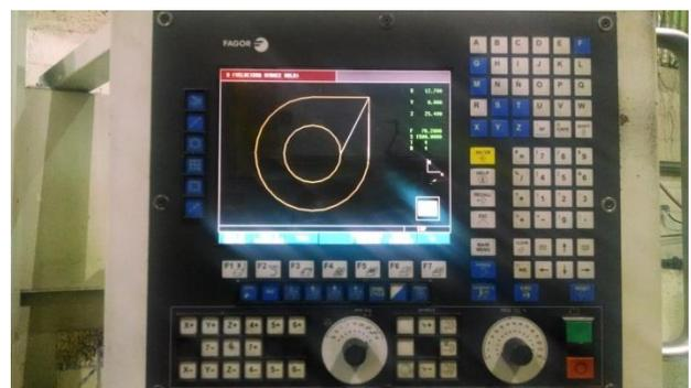
**Figura 7.** Ejecución de programa ejemplo en máquina de 3 ejes marca Fagor
