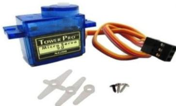
Figura 5 Micro servo para barrido
