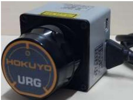
**Figura 6** Sensor láser. (Elaboración propia)
