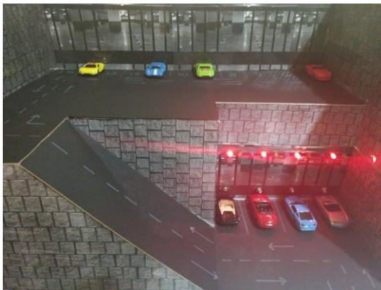
Figura 4 Todos los leds se encuentran de color rojo demostrado que todos los lugares se encuentran disponibles.
