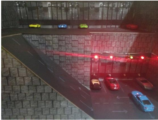
Figura 3 Aquí se muestra que el enciende de color verde al detectar algún lugar disponible.
