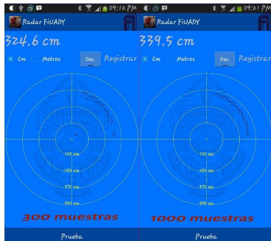
Figura 9 Medición de distancia con 300 y 800 muestras. (Elaboración propia)
