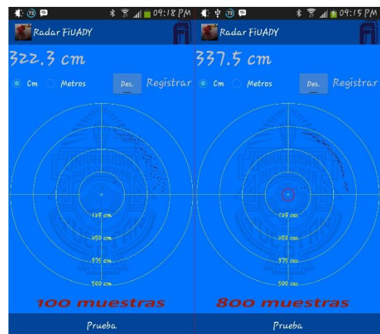
Figura 8 Medición de distancia con 100 y 800 muestras. (Elaboración propia)
