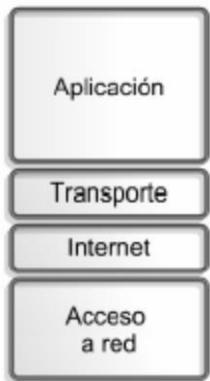
Figura 4 Capas del modelo TCP/IP
