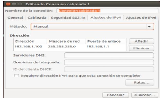
Figura 13 Configuración de dirección ip en una distribución Linux
