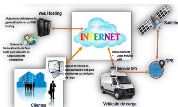
Figura 1 Prototipo conceptual del sistema de geolocalización para vehículos de carga mediante Smartphone
