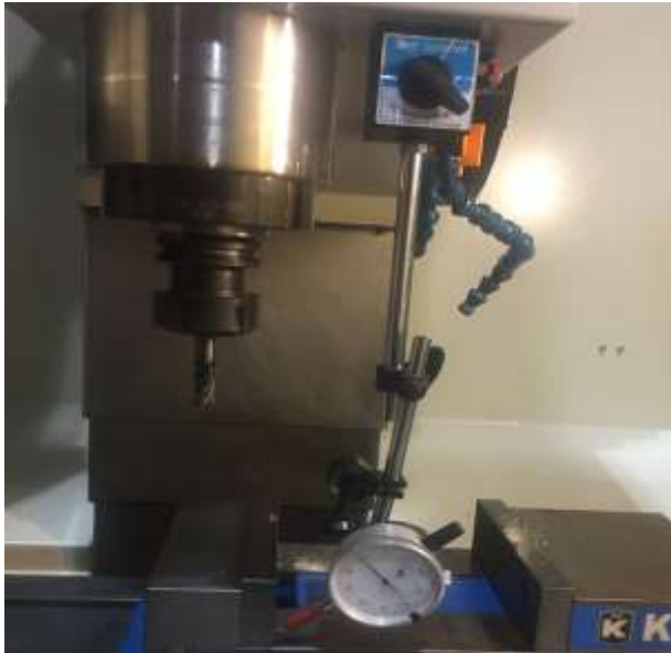
Figura 12 Alienación de prensa utilizando el indicador de caratula
