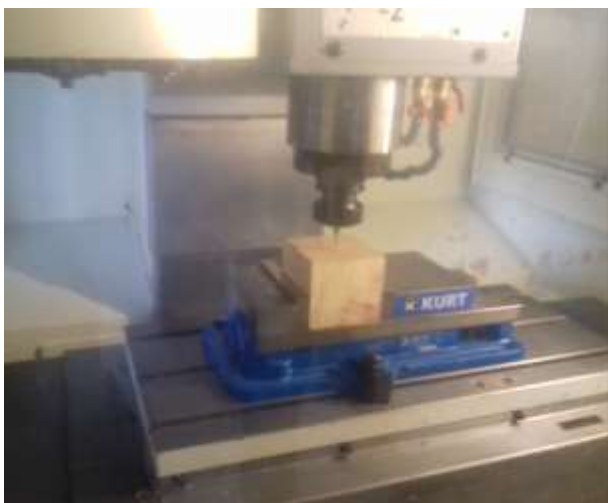
Figura 13 Obtención del cero pieza
