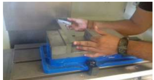
Figura 11 Alineación de prensa utilizando una escuadra
