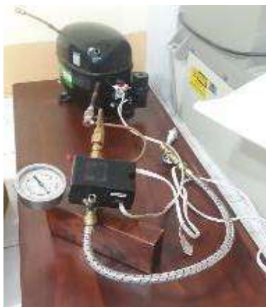
Figura 3 Sistema de compresión de biogás purificado. Fuente: Elaboración Propia
