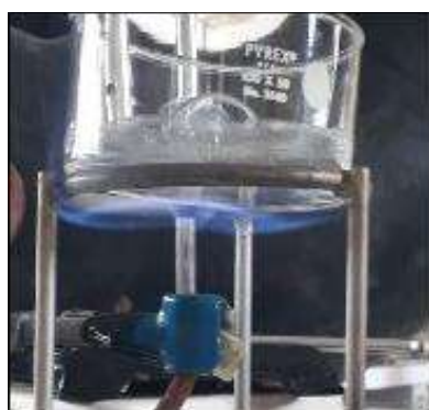
Figura 4 Prueba del poder calorífico Fuente: Elaboración Propia
