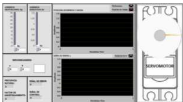
Figura 5 Panel Frontal del Instrumento Virtual del Controlador Proporcional Derivativo en LabVIEW.
