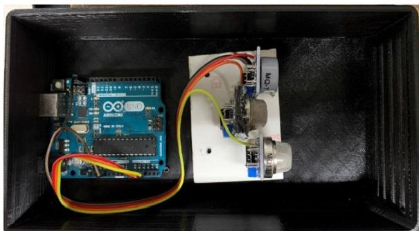
**Figura 5** Prototipo final del dispositivo para la medición de los gases contaminantes (CO, CO<sub>2</sub> y O<sub>3</sub>)
