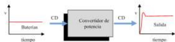
**Figura 1** Diagrama a bloques del convertidor de potencia de CD/CD
