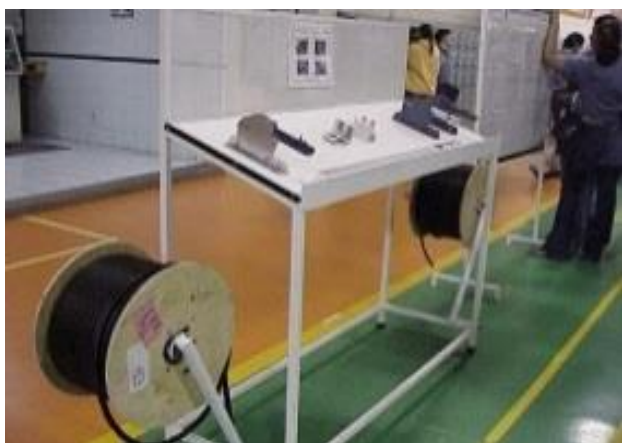
Figura 12 Kaizen de manejo de material después de la implementación
