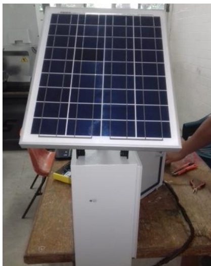
Figura 8 Panel solar instalado sobre el gabinete del transmisor Fuente original
