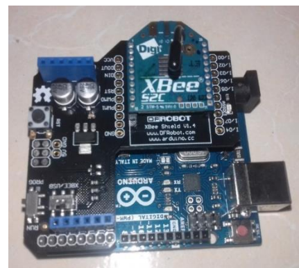
Figura 10 Módulo Xbee ensamblado en el escudo Fuente original
