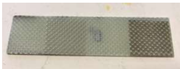
Figura 3 Diferentes tratamientos del láser de CO 2 sobre material compuesto de fibra de vidrio
