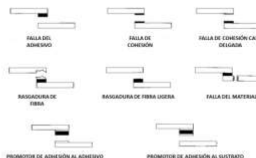
Figura 5 ASTM 5573 Clasificación de modos de falla en uniones con adhesivos
