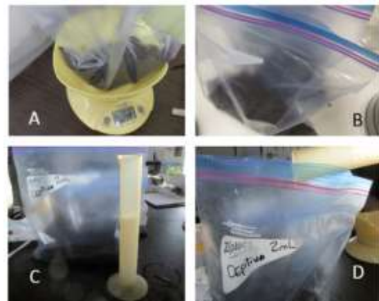
Figura 4 Peso de 360 gramos la arena para realizar la aplicación (A), Bolsa con cada uno de los tratamientos previos a la aplicación (B), cantidad de mezcla 75 ml agregada a los 360 gramos de arena (C), Tratamiento de Ceptiva Duo aplicado a la arena (D).
