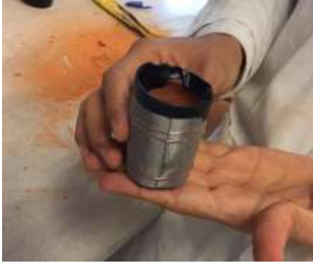
Figura 1 Celda de combustible, armada con recipiente de arcilla y recubierta con malla de acero inoxidable y cobre.
