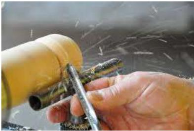
**Figura 1** Proceso de torneado manual.
