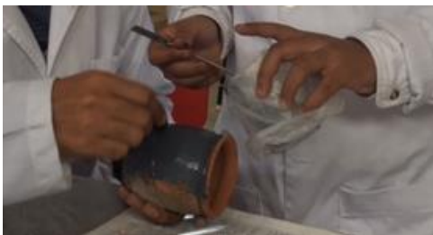
Figura 2 Celda de combustible recubierta con la mezcla de aglutinante con carbón activado y grafito.
