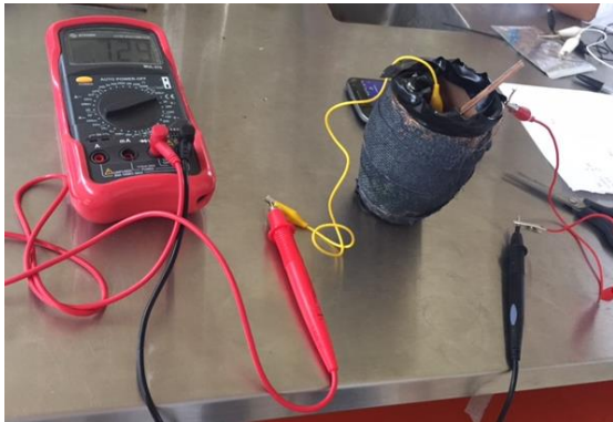
Figura 3 Mediciones de voltaje eléctrico en la celda de combustible microbiana en las muestras de agua residual.
