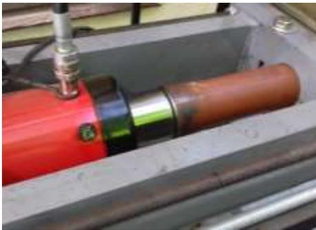
**Figura 6** Dado expandiendo tubo inslado en presa.
