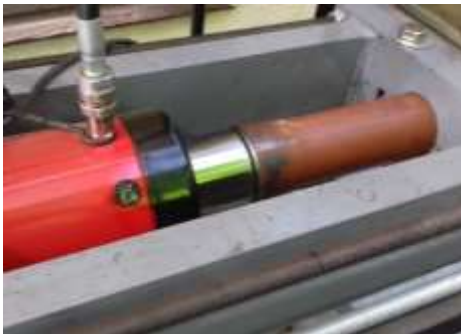
Figura 6 Dado expandiendo tubo inslado en presa.
