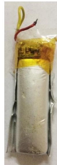
Figura 4 Pila recargable de litio de 3.7 volts a 1500 mAh Fuente: Elaboración propia
