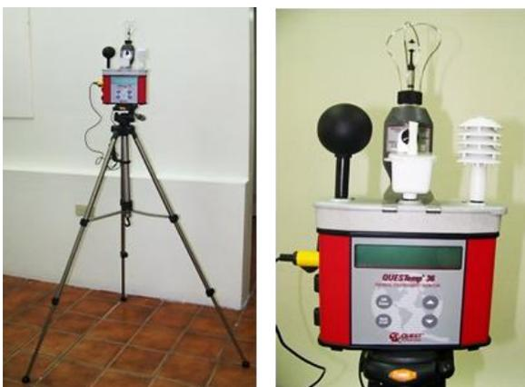
**Figura 1** Monitor de estrés térmico
