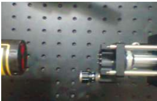
Figura 6 Filtraje espacial, laser, objetivo de microscopio y pinhole , con movimiento en los tres ejes
