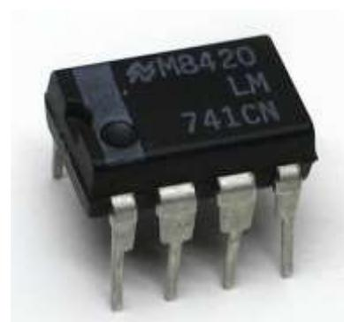
Figura 10 Circuito integrado OPAMP LM741 con encapsulado DIP8 utilizado.
