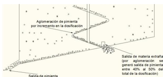
**Figura 5** Aglomeración de pimienta por incremento en dosificación genera que entre el 40% al 50% de la pimienta termine en salida de la materia extraña, creación propia
