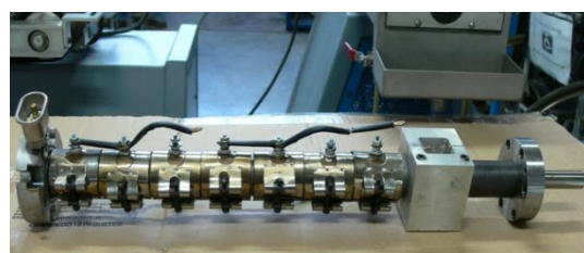
Figura 2 Configuración original de cilindro, husillo y resistencias
