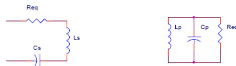
Figura 6 Topologías serie y paralelo del generador
