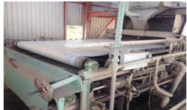
**Figura 1** Prensa de lodos de Bio-Pappel
