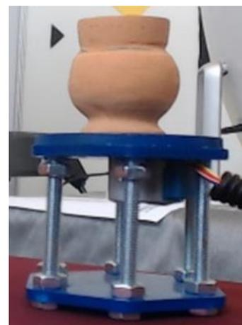
**Figura 8** Mesa giratoria con pieza
