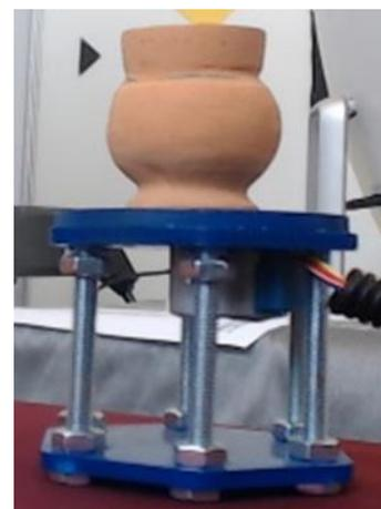
**Figura 8** Mesa giratoria con pieza
