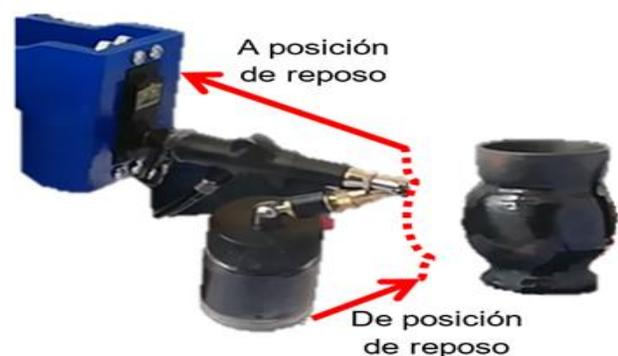
**Figura 5** Trayectoria propuesta para el proceso de pintura
