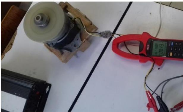
**Figura 22** Arranque del motor conectado al Arrancador Suave
