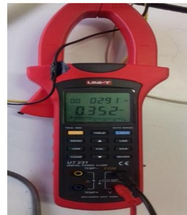
**Figura 26** Medición de factor de potencia
