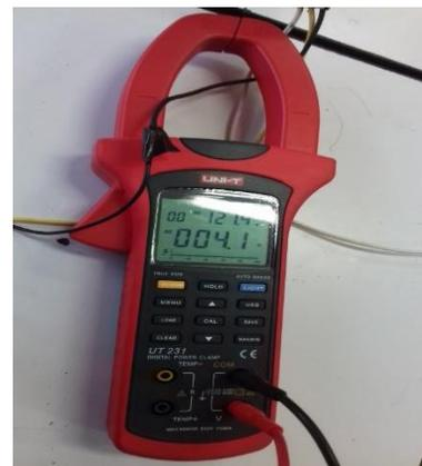
**Figura 25** Medición de corriente mínima al estar activo al 100%
