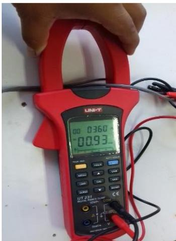
**Figura 28** Medición de potencia en arranque directo de 930 W
