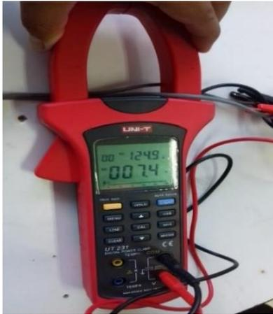
**Figura 21** Medición de potencia en arranque directo
