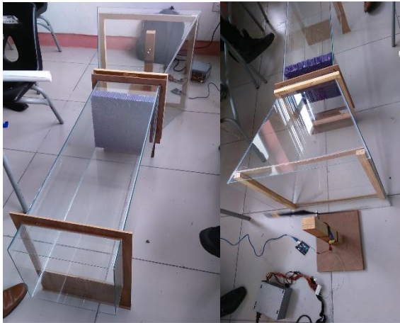
Figura 5 Túnel de Viento Fuente: Elaboración Propia
