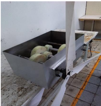
Figura 8b Sistema Eólico en construcción, inicio desarrollo de sistema de orientación
