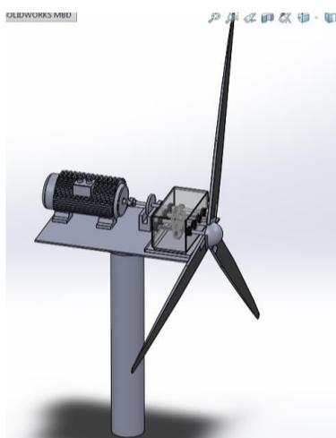
**Figura 1b** Componentes del Aerogenerador
