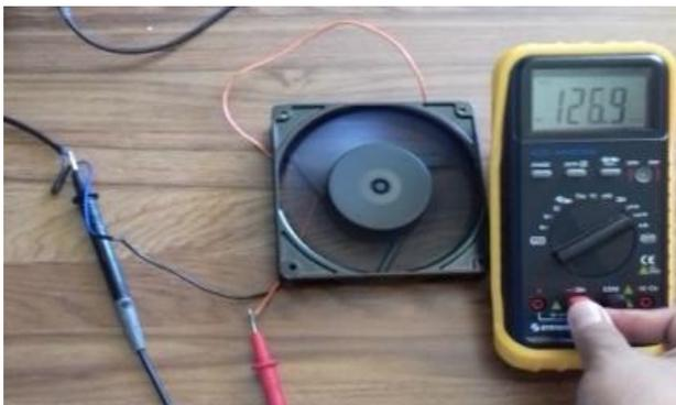
Figura 10 Medición de voltaje en arranque directo
