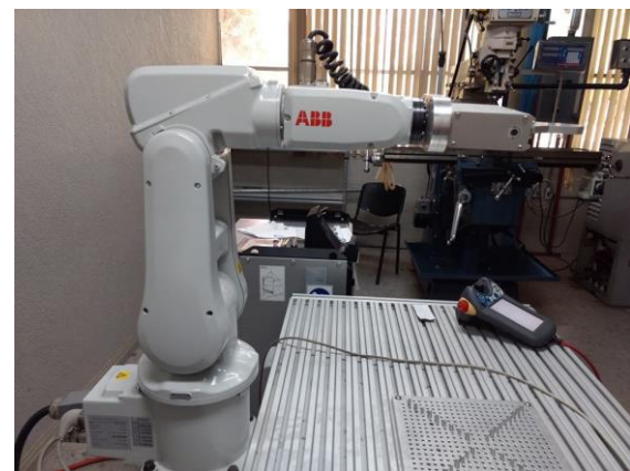
Figura 6 Robot IRB-120 en posición con valores articulares cero
