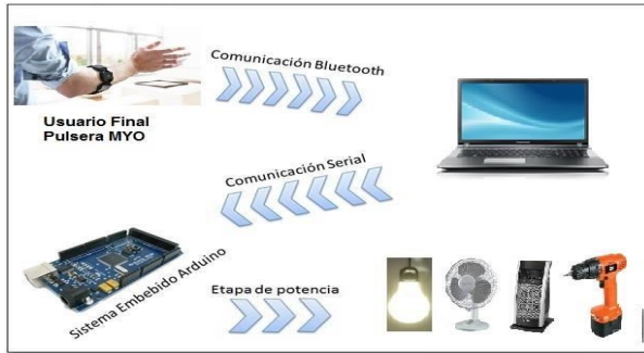
Figura 1 Diagrama de bloques del funcionamiento del sistema
