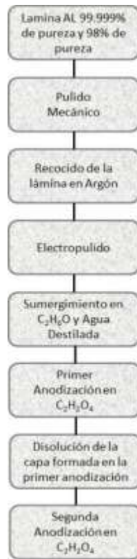
Figura 13 Diagrama de flujo de preparación de sustratos. Fuente: Elaboración Propia
