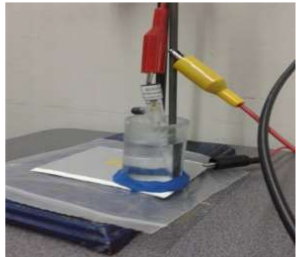
Figura 2 Arreglo experimental de la celda electroquímica
