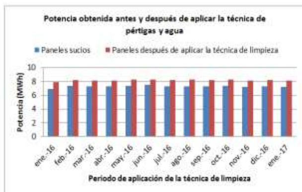
Figura 10 Resultados de potencia obtenidos antes y después de aplicar la limpieza de paneles
