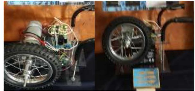
**Figura 12** Prototipo del sistema embebido para la asistencia motriz
