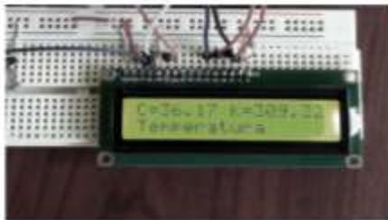
**Figura 18** Datos de temperatura mostrados en LCD
