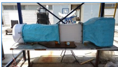
Figura 15 Túnel de viento armado
