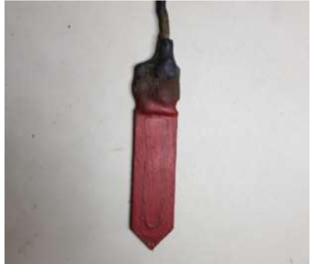
**Figura 12** Sensor CSM cubierto por hule
