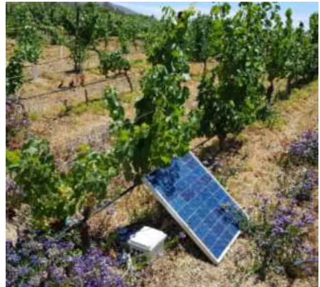
**Figura 9** Nodo de sensores con su respectivo panel solar
