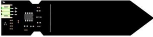
Figura 2 Sensor capacitivo SKU:SEN0193 que mide la capacitancia del suelo, y de ahí se infiere el contenido de humedad
